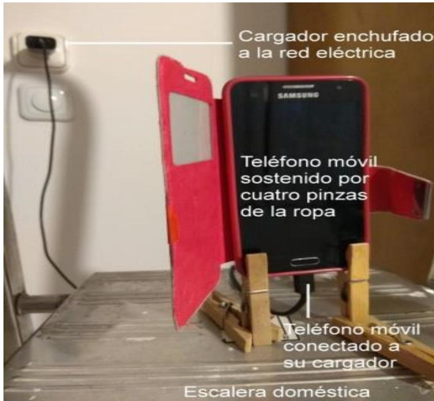
Detalle de cómo se puede sujetar o sostener un teléfono móvil conectado a su cargador sobre una superficie plana, mediante cuatro pinzas (prensas) para la ropa.
